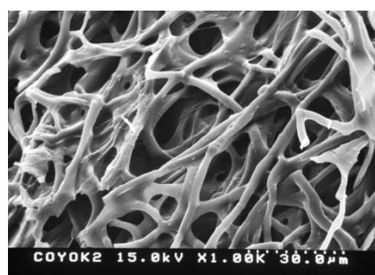
SEM写真 (ペレット断面、線維径3μm)
